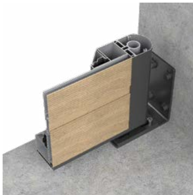
Szczegółowy rzut na górne i dolne mocowania obramowań i profilów, a także na profil z osią obrotową z zawiasami ze stali nierdzewnej INOX 316, z których każdy zdolny jest utrzymać bezpiecznie 250 kg. Największa dopuszczalna powierzchnia skrzydła bramy wynosi prawie 4 m 2 i wytrzymuje podmuchy wiatru o obciążeniu do 2 KPa.
